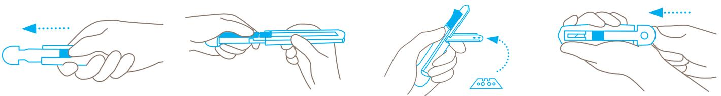
**Drücken** Sie den Kunststoffeinsatz mithilfe des Schiebers nach hinten heraus. Nicht am Einsatz ziehen und gleichzeitig den Schieber festhalten.
