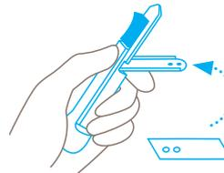
Mithilfe des Zeigefingers Klingehalterung langsam **nach unten aufklappen**, Klinge mit der anderen Hand entnehmen und wenden (für Linkshänder) oder wechseln.
