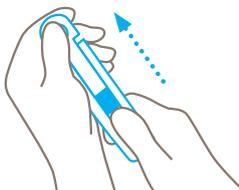
**Drücken** Sie den Kunststoffeinsatz mithilfe des Schiebers nach hinten heraus. **Nicht** am Einsatz ziehen und gleichzeitig den Schieber festhalten.
