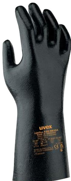
Dieser sehr leichte und flexible Chemikalienschutzhandschuh ist die richtige Wahl, wenn neben Chemikalienschutz und hervorragendem Tragekomfort auch eine hohe elektrische Ableitfähigkeit gefordert ist. Der uvex rubiflex ESD entspricht der aktuellen Norm DIN EN 16350:2014 und hat einen Durchgangswiderstand kleiner als  $10^8$  Ohm. Der uvex rubiflex ESD ist daher ideal für die Anwendung in explosionsgefährdeten Bereichen wie auch in ESD-Bereichen geeignet.
