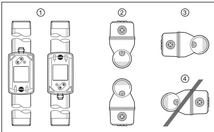
Abb. 1: Ausrichtung der Messstrecke und des Gerätes
