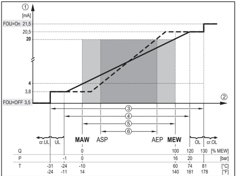
Abb. 1: Ausgangskennlinie Analogausgang nach Norm IEC 60947-5-7.
