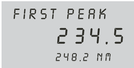
Дисплей в режиме First Peak со значениями крутящего момента
