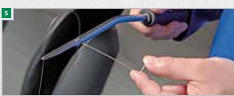
**7** Doblar el extremo del alambre e introducirlo en el taladro del mango del tirador. El alambre se autoafianza cuando el bulón cónico del tirador se somete al esfuerzo de tracción.
