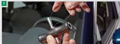
**ATTENTION!** Lors de cette opération de tirage et de desserrage du fil en alternance, il faut veiller à ce que le fil reste tendu. Le fil d'acier risque sinon de se contracter en formant un noeud et devrait être remplacé.
