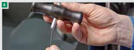
**9** Montøren som arbeider utenfor, griper tak i håndtaket og trekker skjærertråden i retning av kontraholderen som er stukket fast inne i bilen. Herved skiller skjærertråden klebepakningen. Er skjærertråden trukket utover, stikkes kontraholderen inne i bilen inn igjen, forskjøvet et stykke videre. Skjærertråden trekkes da innover av seg selv.
