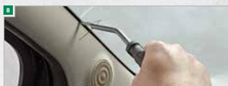
**¡IMPORTANTE!** Proceder cuidadosamente al cortar en los ángulos. Actuar preferentemente centímetro a centímetro. Es aconsejable guiar el hilo de corte por el interior con ayuda de un destornillador. Si a pesar de estas precauciones el alambre se introduce en el canto de la luna, será necesario continuar el proceso de corte en dirección opuesta.
