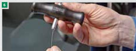
**9** Auton ulkopuolella työskentelevä asentaja tarttuu kahvasta ja vetää leikkulankaa sisäpuolelle kiinnitetyn vastapitimen suuntaan, jolloin liimatiiviste leikkautuu. Kun leikkulanka on vedetty ulos loppuun asti, vastapitimen kärki upotetaan uudelleen tiivisteesseen sisäpuolelta jonkin matkan päähän edellisestä kiinnityskohdasta. Leikkulankaa on vedettävä tällöin tietenkin sisäpuolelle.
