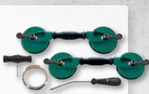
**8** Na rezanie sú potrební dva montéri. Montér vo vnútri vozidla zapichne pridržiavač VERITRAC do samolepiaceho tesnenia 10 až 15 cm od miesta prepichnutia bez toho, aby sa dotkol skla.
