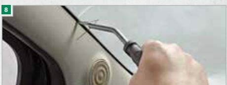
**IMPORTANTE!** Tagliare sugli angoli del vetro facendo molta attenzione. Possibilmente di centimetro in centimetro. Sarebbe meglio guidare il filo da taglio anche con un cacciavite. Qualora il filo da taglio finisca sullo spigolo del vetro nonostante sia stata usata la massima cautela, allora si dovrà continuare l'operazione di taglio nella direzione opposta.
