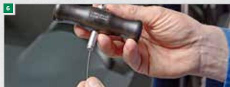
**9** El operario situado en el exterior toma el tirador y tira del alambre en dirección a la sufridera situada por el interior. Al hacer esto el hilo de corte separa el material adhesivo. Repetir sucesivamente esta operación, desplazando cada vez la sufridera un poco más lejos, en el interior, para poder cortar de nuevo. El hilo de corte es atraido cada vez nuevamente hacia el interior.
