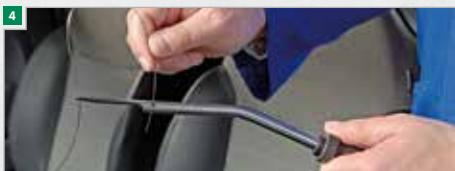
**6** En el exterior, fijar el otro extremo del hilo de corte al tirador VERITRAC introduciéndolo por el interior del bulón cónico hacia la parte superior y haciéndolo pasar, finalmente, por el agujero transversal.
