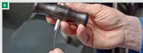
**9** Le mécanicien à l'extérieur saisit le manche et tire le fil à couper dans le sens de la contre-attache introduite à l'intérieur. Ce faisant, le fil à couper détache le matériau d'étanchéité collant. Lorsque le fil à couper est tiré vers l'extérieur, la contre-attache à l'intérieur est à déplacer un peu plus loin et à percer de nouveau dans le matériau d'étanchéité. Le fil à couper est dans ce cas automatiquement tiré vers l'intérieur.
