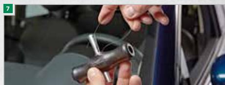
**¡ATENCIÓN!** Durante este proceso alternativo de tensar y aflojar es preciso mantener siempre tenso el alambre. En caso contrario, el alambre corre el riesgo de contraerse formando un nudo que obligará a renovarlo.
