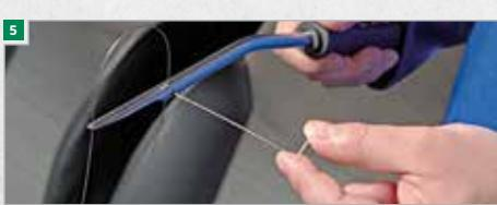
**7** Drôt zahnite a zasuňte ho tiež do otvoru v rukoväti. Drôt sa pri vyvinutí tachového napäťa na čap v rukoväti zaistí sám.
