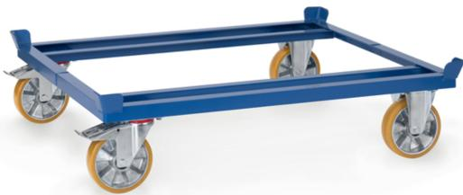
Für Flachpaletten und Gitterboxen. Robuste Winkelstahl-Schweißkonstruktion, mit 4 Fangecken, pulverbeschichtet, blau RAL 5007. 2 Lenk- und 2 Bockrollen, Polyurethan-Bereifung, Naben mit Kugellager, Feststeller an den Lenkrollen, gemäß der europäischen Norm EN 1757-3 (Sicherheit von Plattformwagen). Geringer Rollwiderstand, elastischer Lauf, keine Fahrgeräusche.
