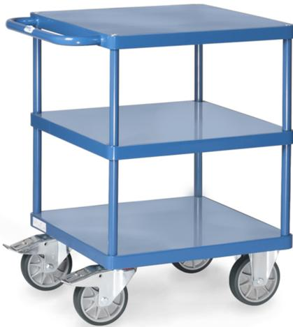
Tischwagen mit dem MultiVario Baukasten-System aus Stahlrohr und Profilstahl geschweißt, pulverbeschichtet brillantblau RAL 5007. 2 Plattformen aus Stahlblech, bündig im Rahmen, sauber eingeschweißt, ebenfalls pulverbeschichtet RAL 5007. 2 Lenk- und 2 Bockrollen, TPE-Bereifung, Naben mit Rillenkugellager. Feststeller an den Lenkrollen, gemäß der Europäischen Norm EN 1757-3 (Sicherheit von Plattformwagen). Tragkraft obere Ladefläche 200 kg.
