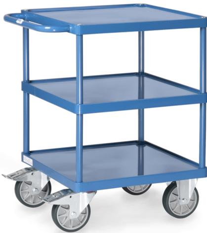
Tischwagen mit dem MultiVario Baukasten-System aus Stahlrohr und Profilstahl geschweißt, pulverbeschichtet brillantblau RAL 5007. 2 Stahlblechwannen mit 10 mm hohem Rand, öldicht verschweißt, pulverbeschichtet RAL 5007. 2 Lenk- und 2 Bockrollen, TPE-Bereifung, Naben mit Rillenkugellager. Feststeller an den Lenkrollen, gemäß der Europäischen Norm EN 1757-3 (Sicherheit von Plattformwagen). Tragkraft obere Ladefläche 200 kg.
