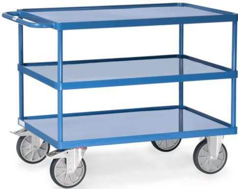
Stahlrohr und Profilstahl geschweißt, pulverbeschichtet RAL 5007. 3 Stahlblechwannen mit 10 mm hohem Rand, öldicht verschweißt, pulverbeschichtet RAL 5007. 2 Lenk- und 2 Bockrollen, TPE-Bereifung, Naben mit Rillenkugellager. Feststeller an den Lenkrollen, gemäß der Europäischen Norm EN 1757-3 (Sicherheit von Plattformwagen). Tragkraft obere und mittlere Ladefläche 200 kg.
