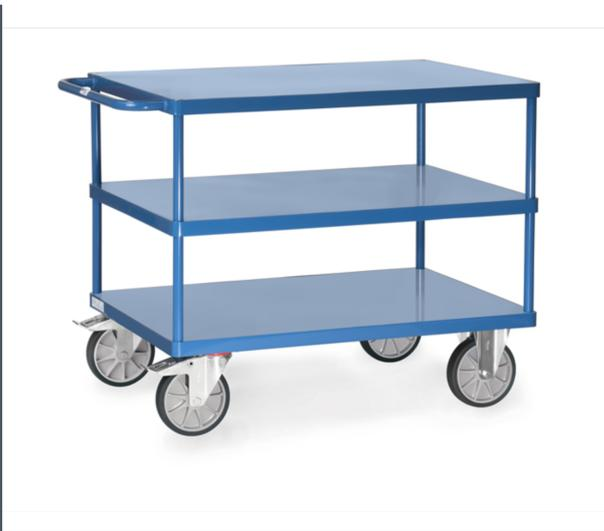
Stahlrohr und Profilstahl geschweißt, pulverbeschichtet RAL 5007. 3 Plattformen aus Stahlblech, bündig im Rahmen, sauber eingeschweißt, ebenfalls pulverbeschichtet RAL 5007. 2 Lenk- und 2 Bockrollen, TPE-Bereifung, Naben mit Rillenkugellager. Feststeller an den Lenkrollen, gemäß der Europäischen Norm EN 1757-3 (Sicherheit von Plattformwagen). Tragkraft obere und mittlere Ladefläche 200 kg.
