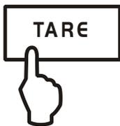
⇒ Waage entlasten und **TARE**-Taste drücken, die Nullanzeige erscheint.
