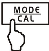
Mit dieser Funktion wird das Gewicht eines Taragefäßes gespeichert. Auch nach dem Aus-/Einschalten arbeitet die Waage mit dem gespeicherten Tarawert weiter.
