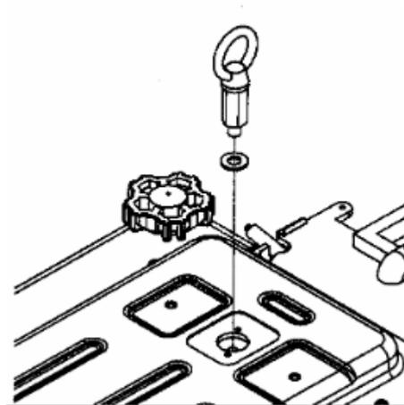
4. Unterlegscheibe über die Bohrung legen und Haken zur Unterflurwägung vorsichtig und vollständig bis zum Anschlag eindrehen (handfest anziehen → Überdrehen kann zur Beschädigung der Waage führen)
