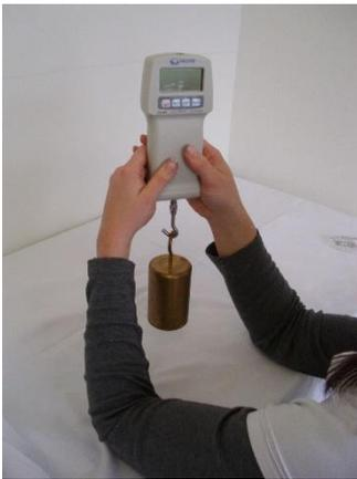
5. Diese Position wird gehalten, bis “F” auf dem Display erscheint. Daraufhin kann das Gewicht entfernt werden und die Justierung ist abgeschlossen. Falls jedoch “E” auf dem Display erscheint – ist Schritt 1. bis 5. zu wiederholen, bis mit “F” eine erfolgreiche Justierung bestätigt wird.
