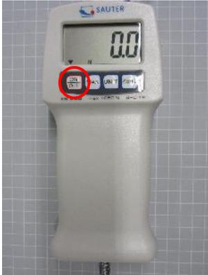
2. Sobald auf dem Display “0” angezeigt wird, ist gleichzeitig die Taste **“UNIT”** und die Taste **“ZERO”** zu drücken, bis **“CAL”** auf dem Display erscheint.
