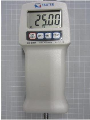
4. Das entsprechende Gewicht wird nun an dem Haken angehängt. Das Gerät **muss stillgehalten werden, während das Gewicht angehängt ist**; ein Zittern ist zu vermeiden. Tipp: das Gerät ist mit beiden Händen zu halten, während beide Ellbogen auf einem Tisch aufgestützt werden oder es an einem festen Gegenstand (Prüfstand) zu befestigen.
