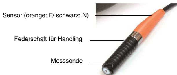
Der Sensor ist am unteren Schaftsegment anzufassen und wird nur leicht auf das Prüfobjekt angedrückt.
