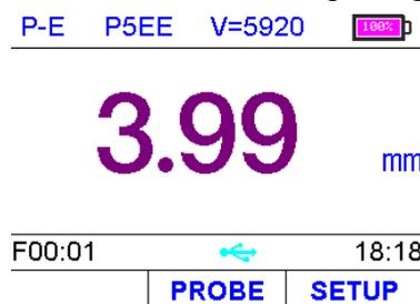
**Scan Mode** [*Scanmodus*]. Neben dem letzten Dickenmesswert werden auch der minimale und der maximale Dickenwert während der Messung angezeigt.
