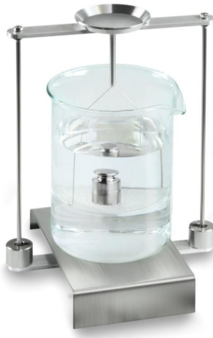
Abb.2: „Wägung in Hilfsflüssigkeit“
