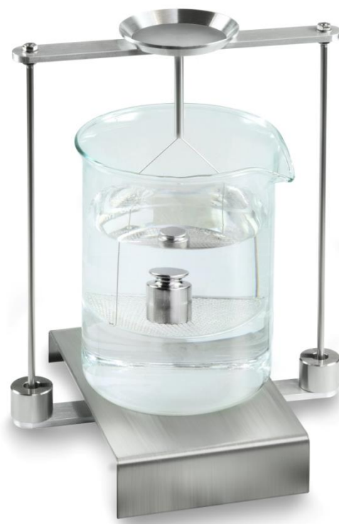
Abb.2: Wägung in Prüfflüssigkeit
