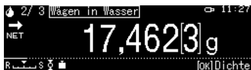
Abb.2: Wägung in Prüfflüssigkeit
