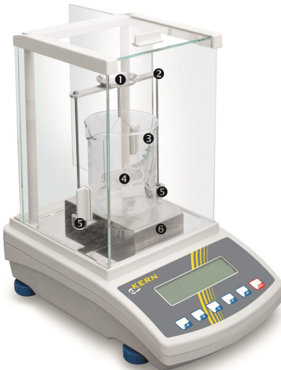
Abbildungsbeispiel mit installiertem Dichtesets KERN YDB-03
