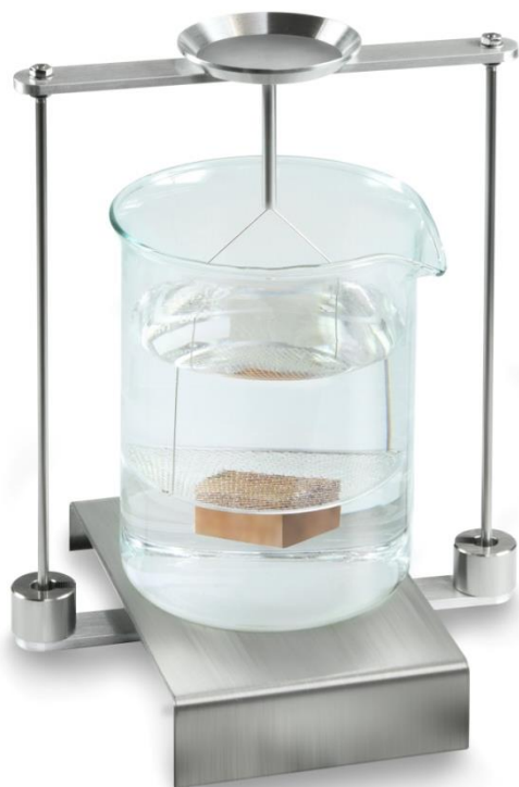
Abb.4: Wägung in Hilfsflüssigkeit
