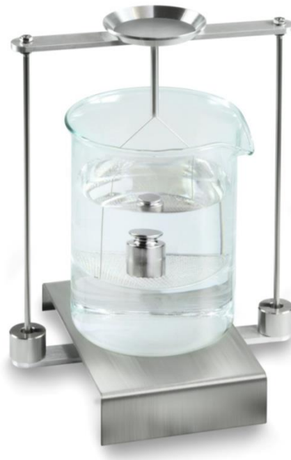
Abb.2: „Wägung in Prüfflüssigkeit“
