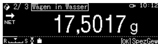
Abb.2: Wägung in Hilfsflüssigkeit
