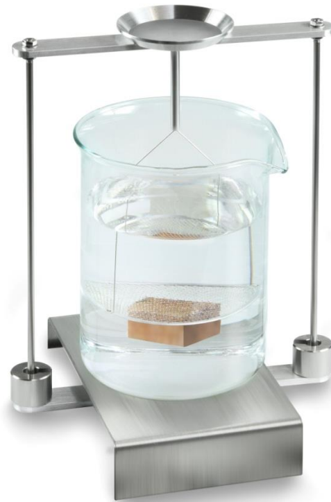
Abb.4: Wägung in Hilfsflüssigkeit
