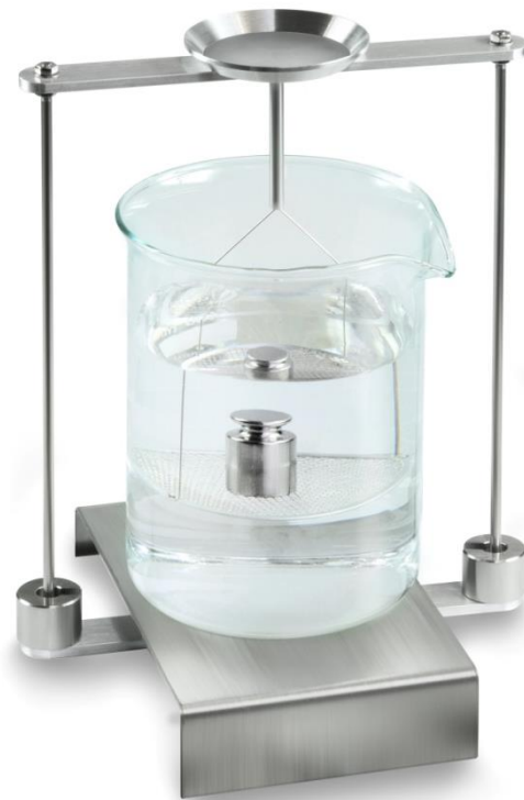
Abb.2: Wägung in Hilfsflüssigkeit
