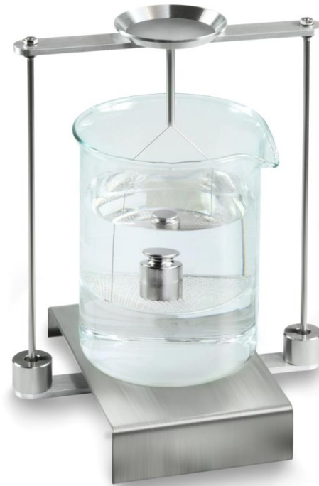
Abb.6: Wägung in Prüfflüssigkeit
