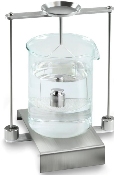
Abb.6: Wägung in Prüfliquidität
