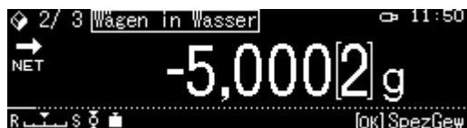
Abb.4: Wägung in Hilfsflüssigkeit
