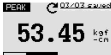
Die Pfeiltasten UP bzw. DOWN drücken, um die Speichermaske zu ändern. Die Taste drücken und gedrückt halten, um in die Position der Änderung der Speichermaske zu scrollen. Durch das Drücken der Taste PRINT wird die Druckausgabe von abgespeicherten und per seriellen Port übertragenen Daten angesteuert. Um in die Menümaske *DELETE* zu gelangen, die Taste ZERO drücken.
