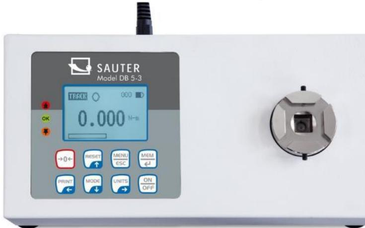
Um das Gerät einzuschalten, die Taste ON/OFF drücken. Nachdem erfolgt ein kurzer Autotest, bei dem auf dem Display der zulässige Belastungswert in Newton angezeigt wird.
