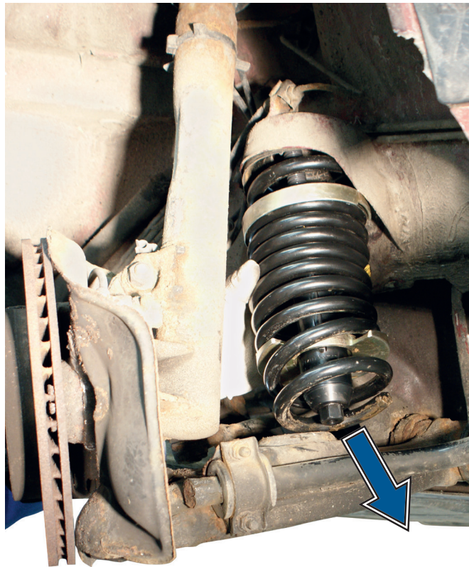
📸9: Position der Druckplatten an der Feder markieren.
