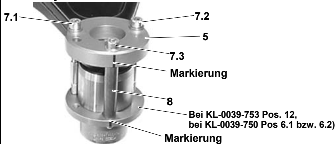
Abb. 8: Pressrahmen an Querlenker ansetzen, Traggelenk ausbauen.
