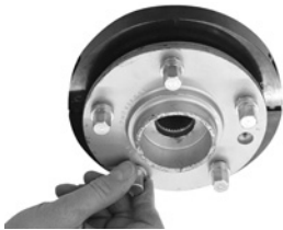
Abb. 5: Werkzeug am Achschenkel montieren.
