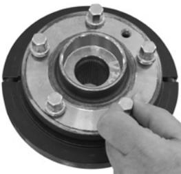
Abb. 9: Werkzeug am Achschenkeln montieren.
