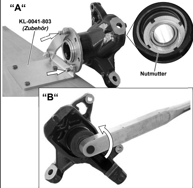
Abb. 2: Zentralbefestigungsmutter am Radlager lösen.
