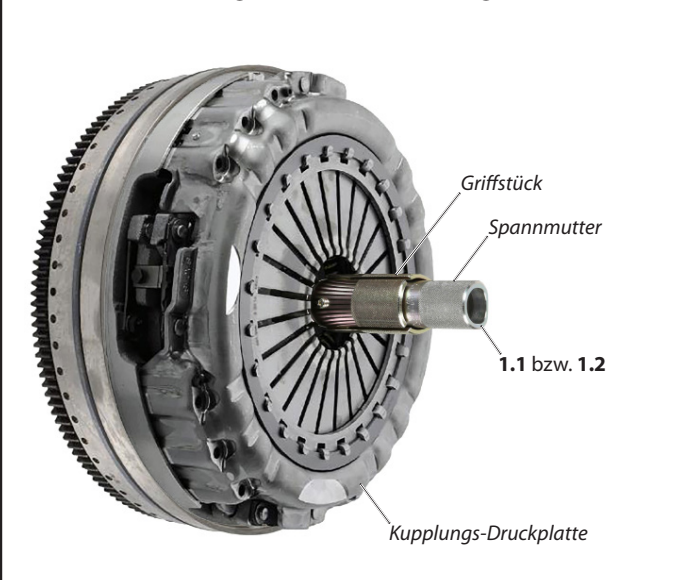
Abb. 9: Kupplungs-Druckplatte montieren und nachfolgend Zentrierwerkzeug entfernen.
