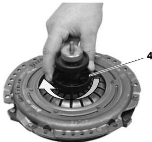
Abb. 5: Kupplungsscheibe ausrichten.
