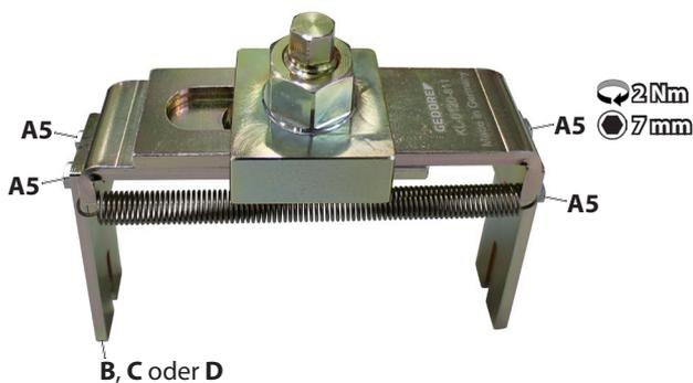
2. Montieren Sie den ausgewählten Adaptersatz **[B] - [F]** wie gezeigt, am Grundgerät **[A]** und drehen die Schrauben **[A5]** mit **2 Nm** fest.
