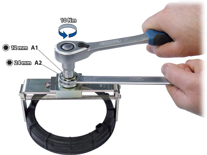
**4:** Tankverschlussring nach Herstellervorgaben lösen bzw. festziehen...
