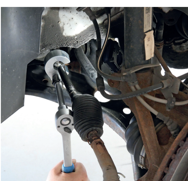
📷 3: Innere Spurstange lösen bzw. festziehen.
