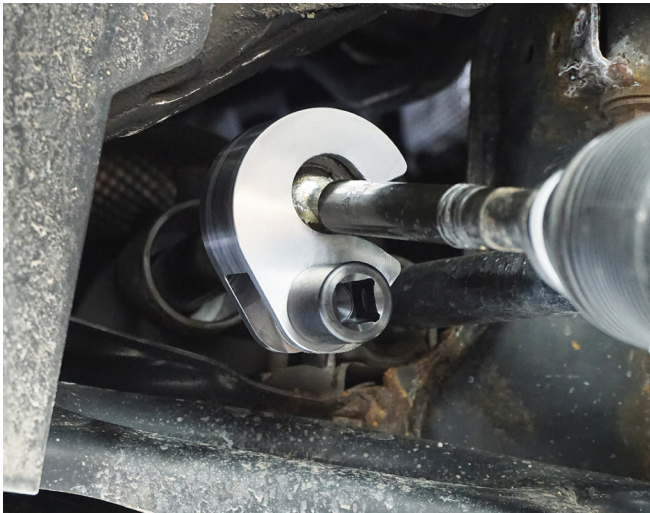
📷 3: Innere Spurstange lösen bzw. festziehen.
