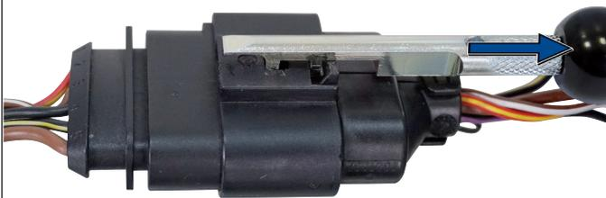
1. Entriegelungswerkzeug wie gezeigt von **hinten** am Kabelstecker ansetzen.
