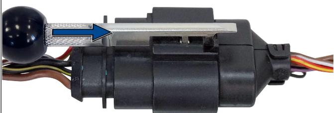
1. Entriegelungswerkzeug wie gezeigt von **vorne** am Kabelstecker ansetzen.
