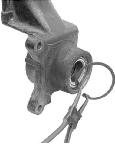
**KL-0192-5 - Sicherungsringzange Ø40-100**
