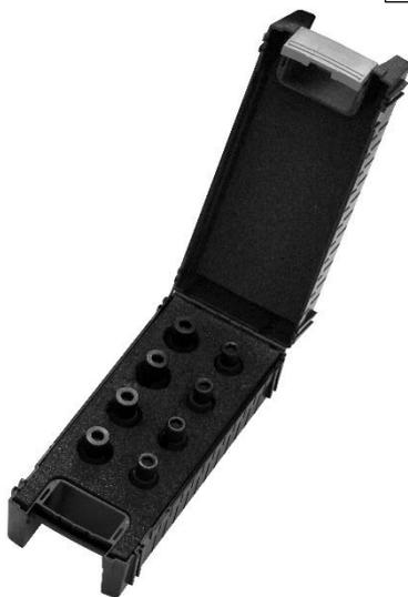
**KL-0220-10 K - Fixierwerkzeug VW Aggregateträger**
