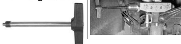
**Achtung:** Beim Lospressen von stark eingerosteten SK-Klemmschrauben kann sich am Schraubenschaft ein starker Wulst bilden. Der Wulst muss entfernt werden, z.B. mit einem Trennschleifer. Hierzu Werkzeug abmontieren und nach Entfernung des Wulstes Werkzeug wie in Punkt 3 bis 5 beschrieben wieder montieren und Auspressvorgang fortführen.
