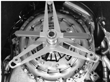
Abb. 3: Druckplatte mit KL-0500-45 vorspannen und montieren.
