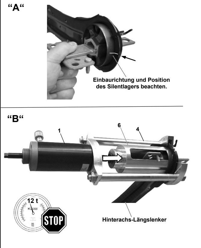
Abb. 4: Silentlager einbauen.
