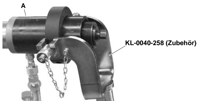
Abb. 3: Hydraulik-Zylinder in Aufnahmevorrichtung einbauen.
