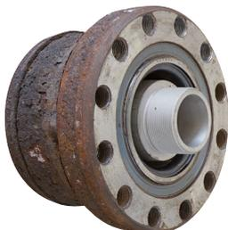
**B** Radnaben-/Lagereinheit bei Tiefladern vorbereiten.
