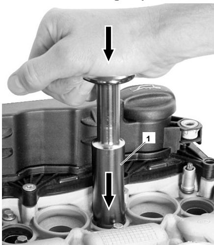
**KL-1383-30 - Dichtringmontage-Werkzeug,
