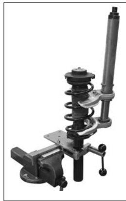
Abb. 8. Feder- / Dämpferbein einspannen
