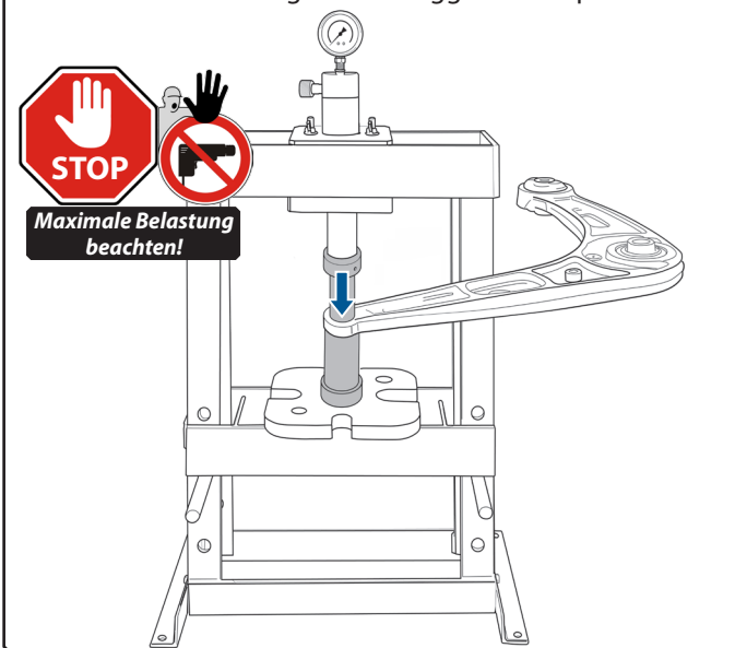
📷 14: Silent-/Gelenklager bzw. Traggelenk auspressen.
