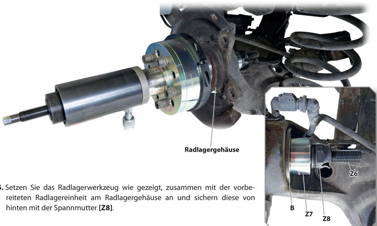
5. Setzen Sie das Radlagerwerkzeug wie gezeigt, zusammen mit der vorbereiteten Radlagereinheit am Radlagergehäuse an und sichern diese von hinten mit der Spannmutter [Z8].
