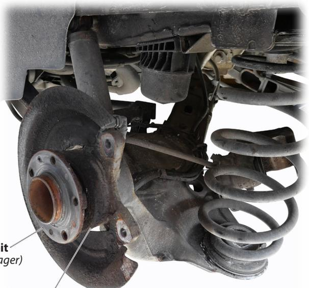
**☞ 4: Abziehplatte [A] an der Radnabe verschrauben...**
