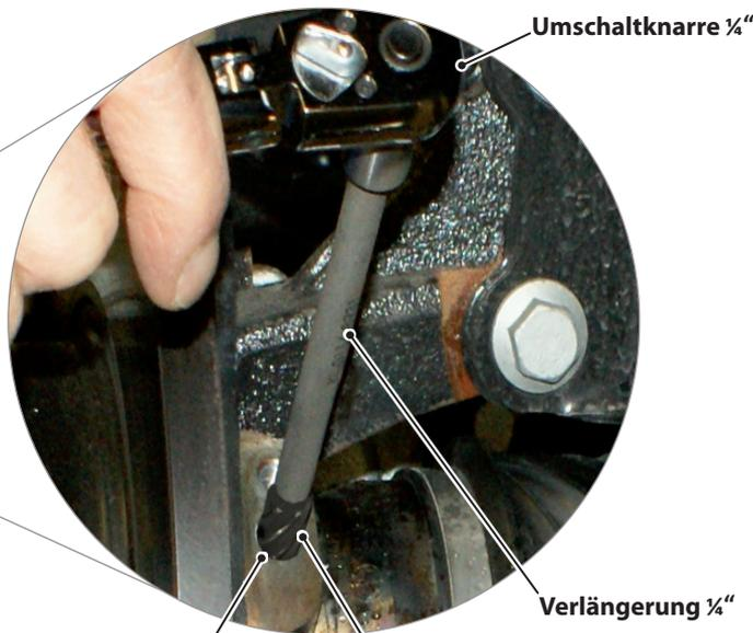
Aufnahmebohrung für ABS-Sensor
