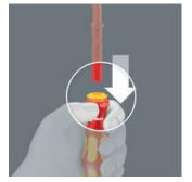
Die Kraftform Kompakt VDE Wechselklingen lassen sich einfach durch das Herunterziehen des gelben Rings am Handgriff austauschen.
